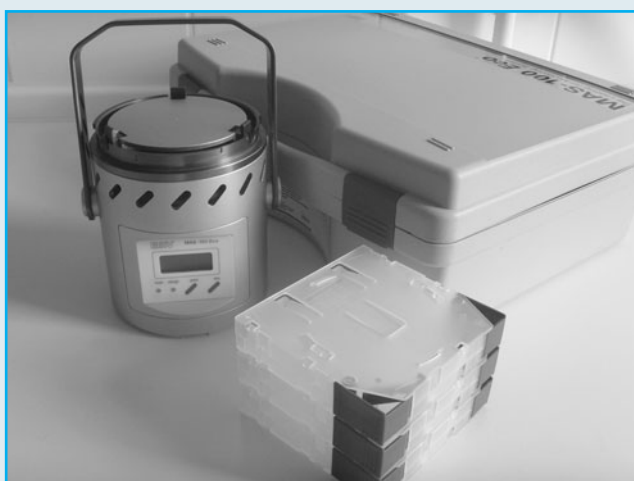
Obr. 3 Přístroj aeroskop MAS - 100 Eco (Merck, Německo) pro stanovení mikrobiologické kvality ovzduší.
