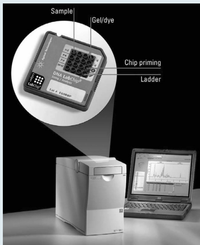
Obr. 1 Separace DNA pomocí mikrofluidního analyzáru.
