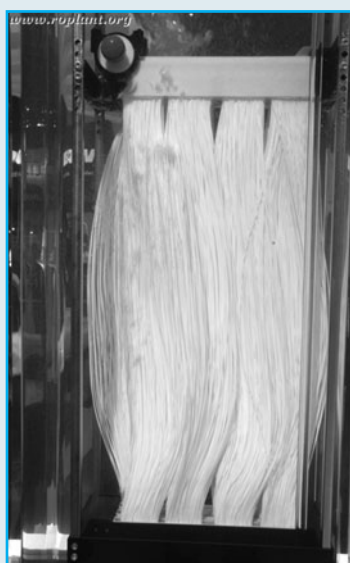
Obr. 3 Ukázka ponorného modulu s dutými vlákny
