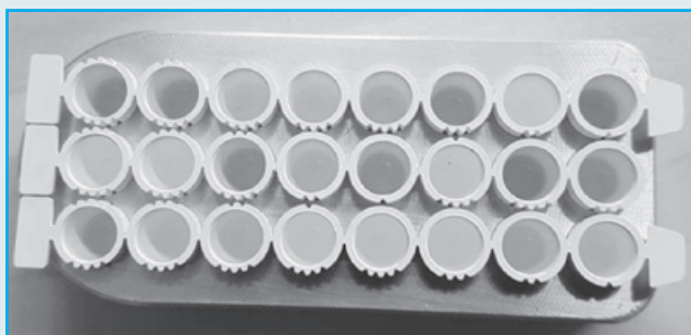
Obr. 4 Barevná reakce po provedení kvantitativního testu na obsah progesteronu v mléce pomocí přístroje eProCheck® 2.0.
